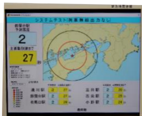
緊急地震速報システムの表示画面
