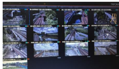
河川橋梁部状況 監視画面（PC上）
